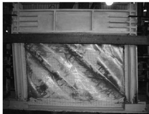
ج) شکل تغییر شکل یافته نمونه مورد آزمایش و همخوانی فرم تغییر شکلی نمونه آزمایش با مدل عددی
