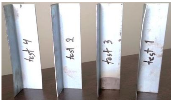
شکل ۱۳- چهار نمونه مقطع فولادی سرد نورد شده با طول ۲۵۰ mm
