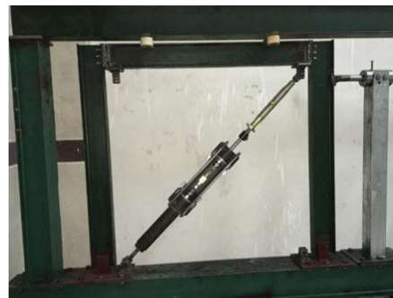
شکل ۱- میراگر اینرسی دورانی اصطکاکی ساخته شده در آزمایشگاه زلزله دانشگاه ارومیه
