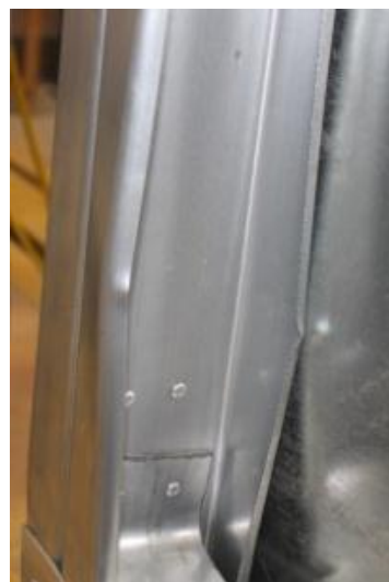
شکل ۵- کمانش موضعی ستونک
