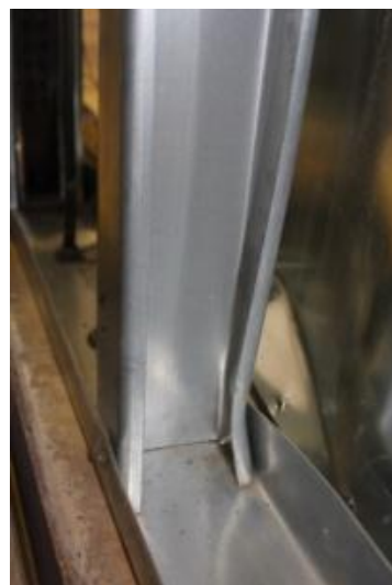
شکل ۵- کمانش موضعی ستونک
