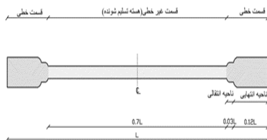
شکل ۴- مشخصات مهاربند کمناش تاب
