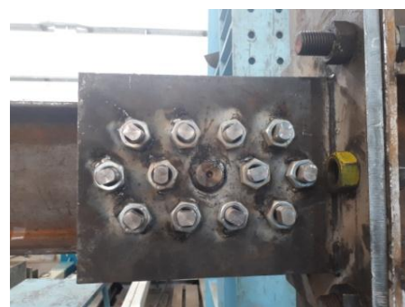
شکل ۲۵- اتصال نمونه آزمایشگاهی (CPYD1) به ستون
