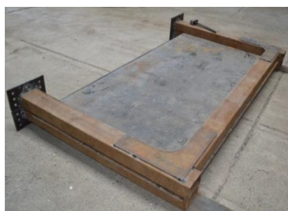
ب) تصویر ناحیه عدم اتصال ورق جان به المان مرزی قائم در نمونه ساخته شده ج) تصویر ناحیه عدم اتصال ورق جان به المان مرزی قائم در مراحل ساخت و نصب نمونه
