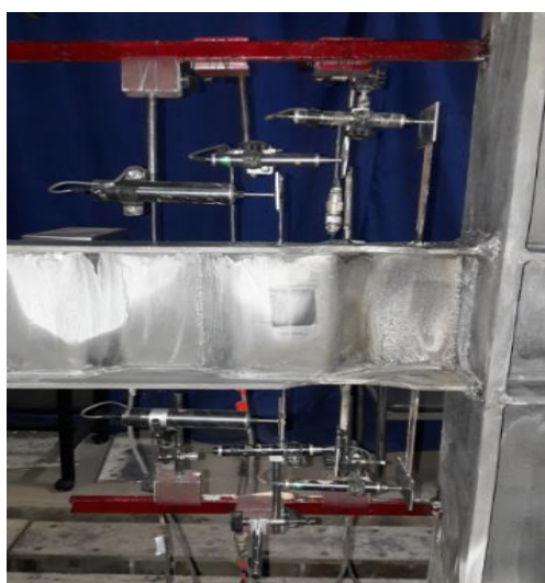
شکل ۷- موقعیت نصب جابه‌جایی سنج‌های (LVDT) نمونه‌های آزمایشی
