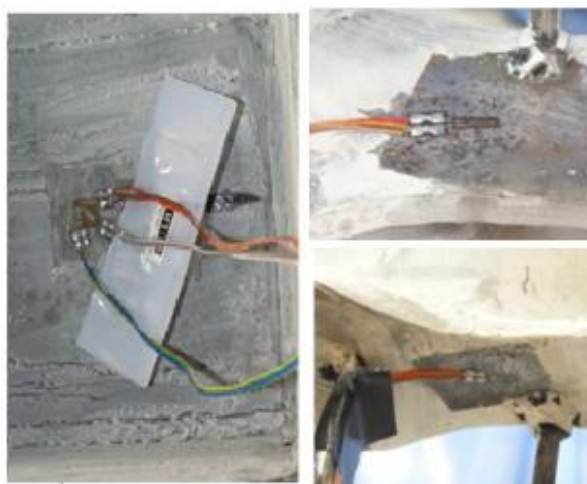
شکل ۸- موقعیت کرنش سنج‌های نصب شده در نمونه
