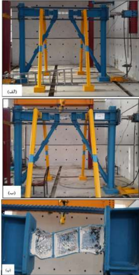
شکل ۱۶- قاب مهاربندی مجهز شده به فیوز SRF، الف: قبل از انجام تست، ب: بعد از انجام تست، پ: نمای نزدیک فیوز بعد از انجام تست [۲۷]
