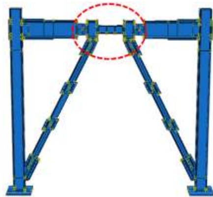
شکل ۲- فیوز تعویض‌پذیر SRF و موقعیت قرارگیری آن در قاب واگرا
