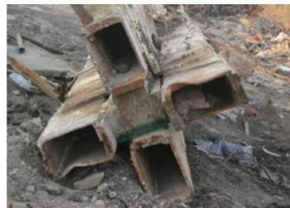
شکل ۱- تخریب ستون‌های ساختمان پلاسکو در درجه حرارت‌های بالا در هنگام حریق
