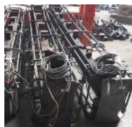
(پ) نصب کرنش‌سنج
