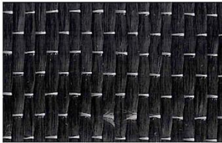
شکل ۴- بافت ظاهری الیاف پلیمری کربن مورد استفاده در غلاف مهاربند کمانش تاب
