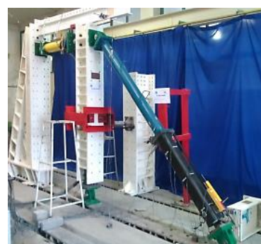
شکل ۲۴- مهاربند کمانش تاب با غلاف بتنی در سامانه انجام آزمایش قاب جزء (نمونه دوم)
