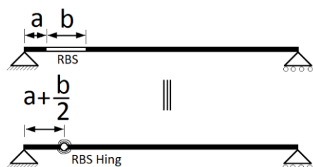
شکل ۸- مدل سازی تیر RBS با تیر مقطع کامل و فنر
