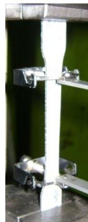
الف) نمونه در دستگاه آزمایش (ب) باریک شدگی و گسیختگی نمونه
