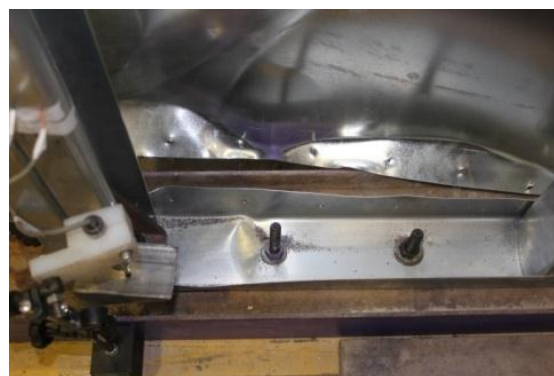
شکل ۶- کمانش و بالا آمدگی تیرک
