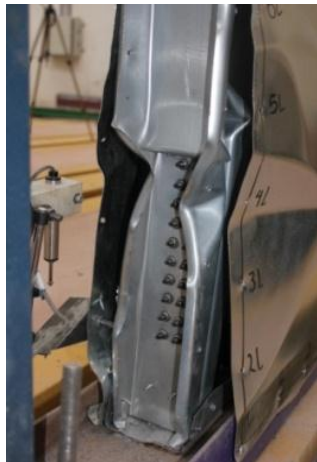
شکل ۸- کمانش موضعی ستونک کناری، بیرون آمدگی پیچ و جدا شدگی پوشش از قاب فولادی
