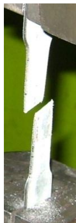
الف) نمونه در دستگاه آزمایش (ب) باریک شدگی و گسیختگی نمونه
