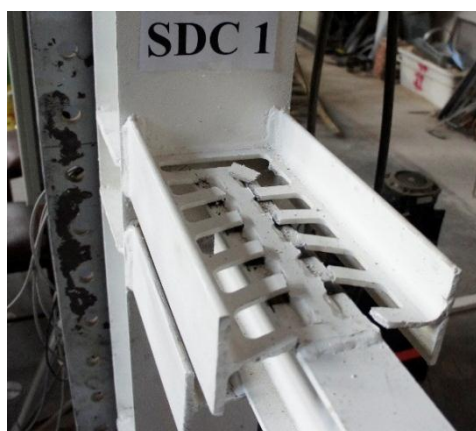
شکل ۱۰- نمونه SDC1 در انتهای بارگذاری
