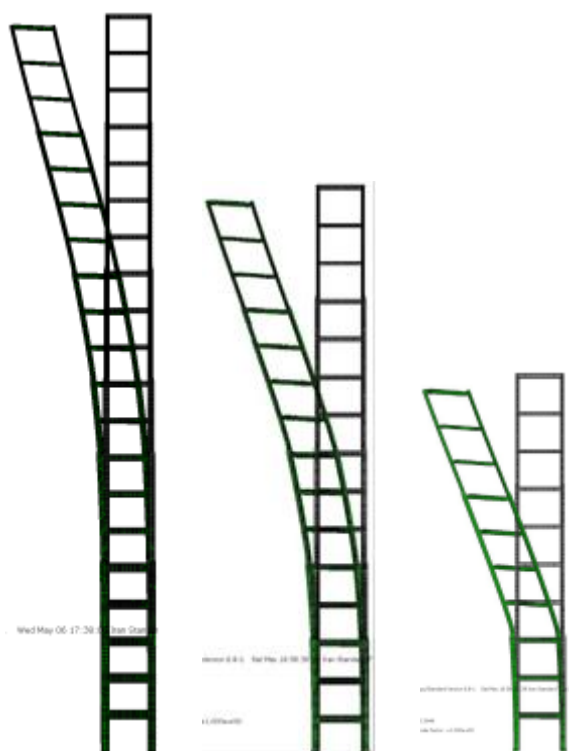
شکل ۱۴- تغییر شکل ها بعد از تحلیل قاب های خمشی
