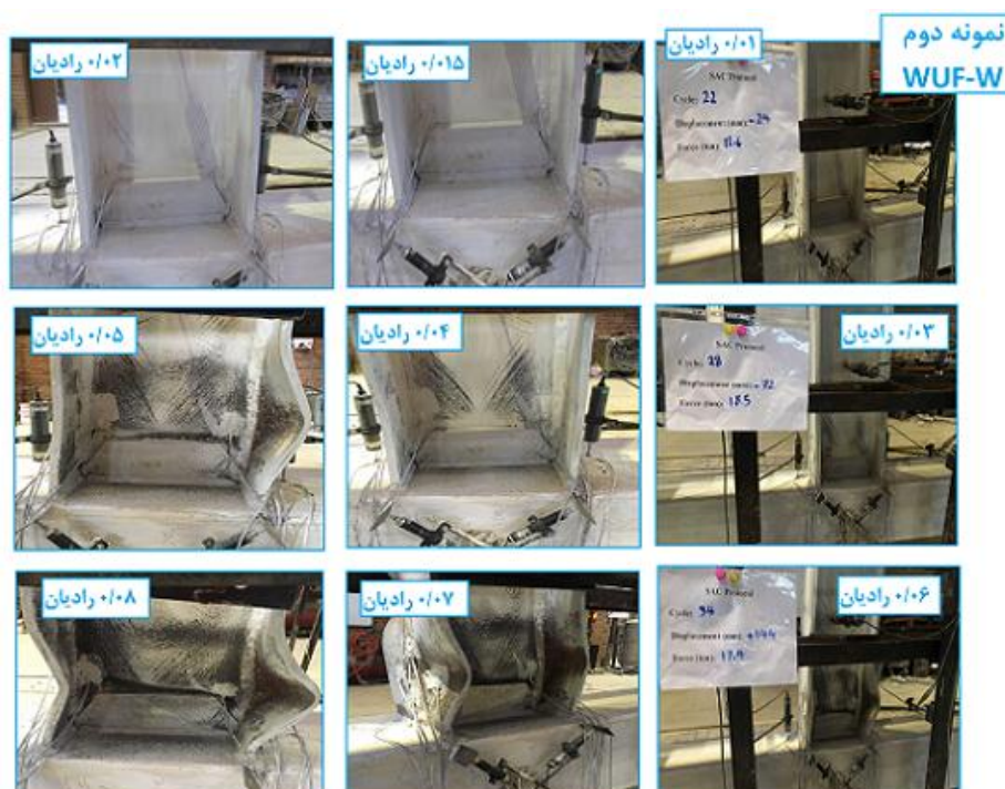
شکل ۱۷- نمونه دوم اتصال خمشی WUF-W تا رسیدن به بیشینه بازه تغییرشکلی ۰/۰۸ رادین پروتکل بارگذاری SAC
