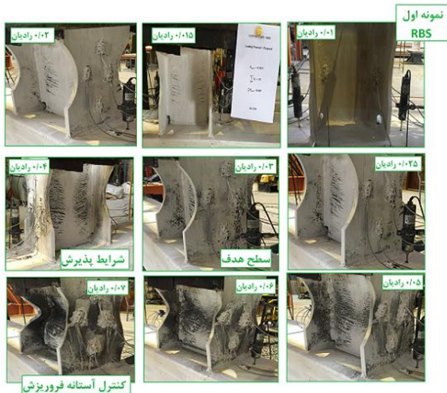
شکل ۲۰- نمونه اول اتصال RBS در مقادیر هدف، شرایط پذیرش و کنترل آستانه‌ی فروریزش پروتکل بارگذاری ملی
