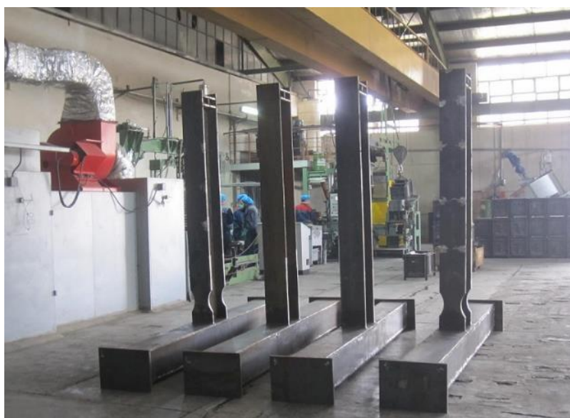
شکل ۱۰- ساخت و مونتاژ چهار نمونه آزمایشگاهی (یک جفت اتصال خمشی WUF-W و یک جفت اتصال خمشی RBS)
