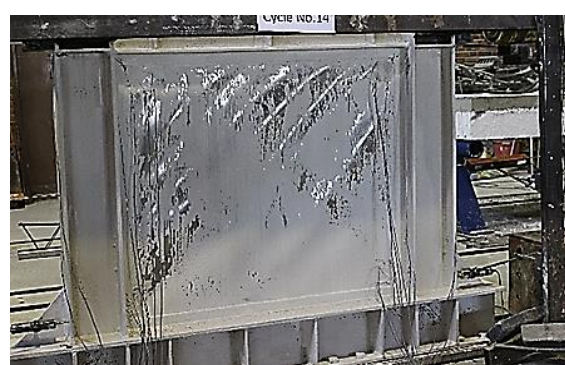
شکل ۱۰- وقوع کمناش دائمی ورق جان در جابجایی ۰/۷٪
