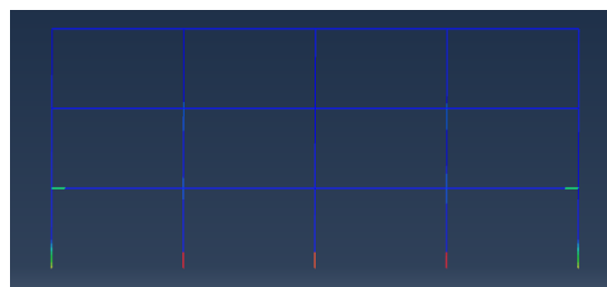
شکل ۷- محل کرنش‌های پلاستیک مدل سه طبقه ناشی از توالی لرزه‌ای تحت رکورد Northridge
