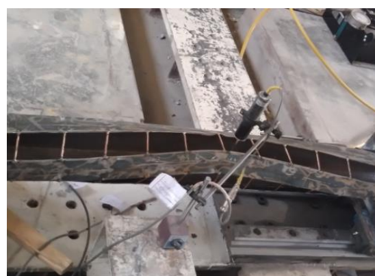
شکل ۱۷- تسلیم و کماتش کلی نمونه
