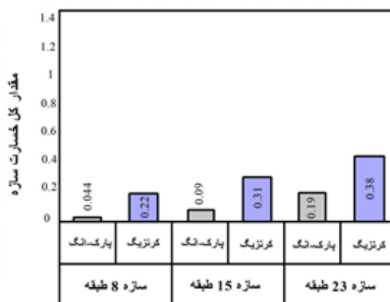
شکل ۱۶- متوسط خسارت‌های کل سازه ۸، ۱۵ و ۲۳ طبقه دارای سیستم دوگانه تحت زمین‌لرزه‌های حوزه دور
