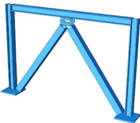
شکل ۳- نحوه استقرار میراگر پیشنهادی در قاب بهسازی شده
