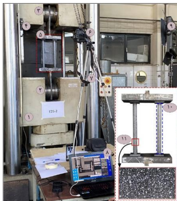
شکل ۱۴- محیط آزمایشگاه- (۱) دستگاه کشش- (۲) فک ثابت (۳) فک متحرک- (۴) تغییر مکان سنج خطی- (۵) نمونه آزمایشگاهی (۶) دوربین عکس‌برداری- (۷) سه‌پایه- (۸) لپ‌تاپ- (۹) نورپردازی (۱۰) سطح مورد بررسی- (۱۱) الگوی رنگی سیاه و سفید
