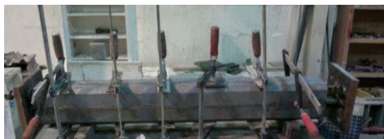
شکل ۲۲- مونتاژ نمونه (استقرار غلاف رویی بر روی غلاف زیرین و بستن دو غلاف با گیره)
